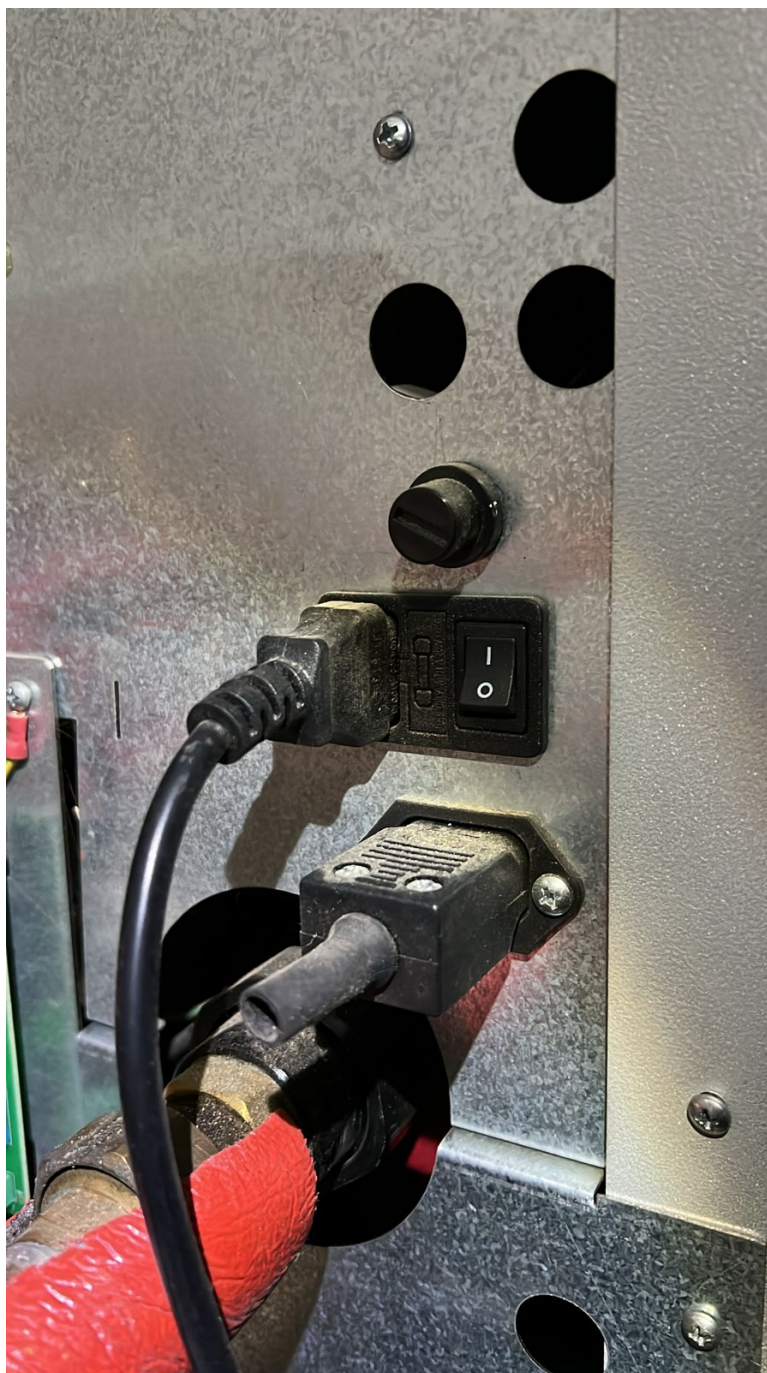
Рисунок 9. Установленный, на заводе кабель питания, с трапецевидным коннектором, обозначен маркировкой "220 V".
